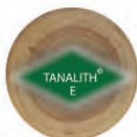
► A petición del cliente nuestros productos se puede suministrar secados (con la humedad de 20-25%) o impregnados (hasta clase de protección IV). La impregnación se realiza con TANALITH E 3475 que no contiene arsénico y cromo. Los productos impregnados tienen un color verdoso y su vida útil en condiciones desfavorables (en contacto con tierra y agua) es como mínimo 10 años.
